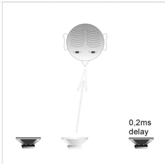
figuur 1.37 : vertraag je het rechter signaal met 0,2msec. zal het spookbeeld zich naar links verplaatsen
