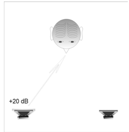
figuur 1.36 : verhoog je het linker kanaal 20 dB dan zal de informatie van het rechterkanaal wegvallen
