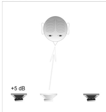
figuur 1.35 : verhoog je het niveau van het linker kanaal dan zal het spookbeeld naar links bewegen
