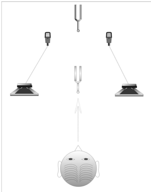
figuur 1.33 : bij een goede balans wordt een spookbeeld weergegeven
